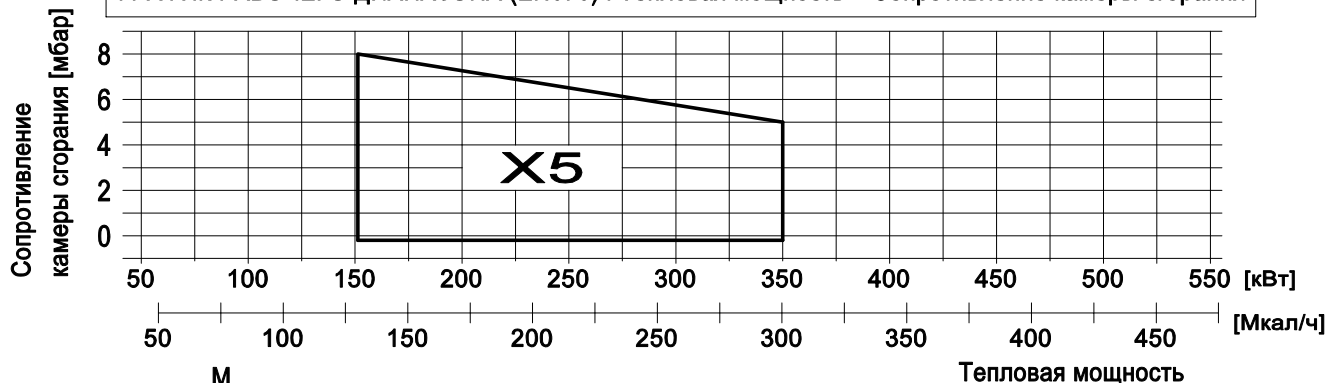
ГРАФИК РАБОЧЕГО ДИАПАЗОНА (EN676) : Тепловая мощность – Сопротивление камеры сгорания
